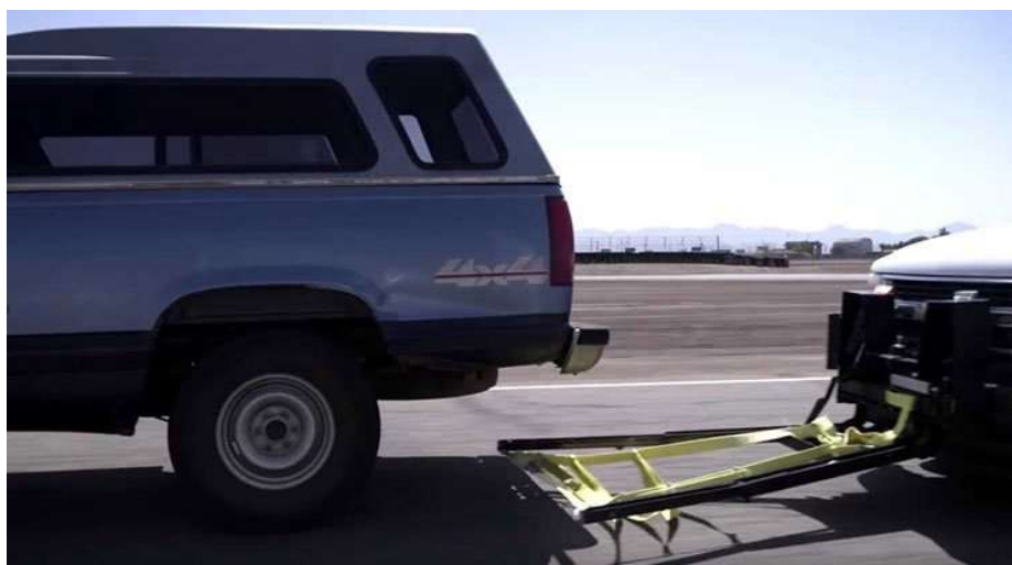
Obrázek 32 - Grappler Police Bumper záběr z testování 104
