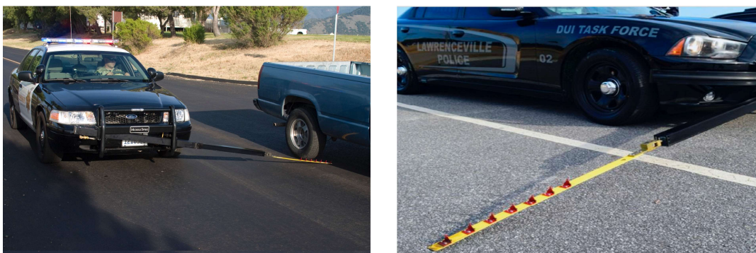
Obrázek 33 – Mobile Spike namontovaný na policejním vozidle při použití a v roztáženém stavu na zaparkovaném policejním vozidle 106
