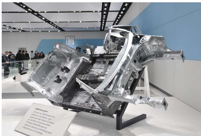
Obrázek 1 - Platforma MQB koncernu VW, základ konstrukce vozidla, na které je namontovaný Policejní rám 33
