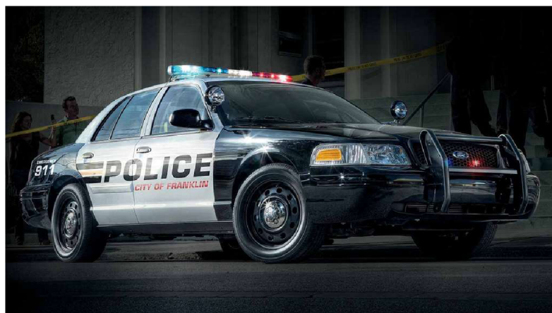
Obrázek 23 - "Crown Vic" 4.6L 8V POLICE City of Franklin včetně Spotlights a rámem SETINA 84
