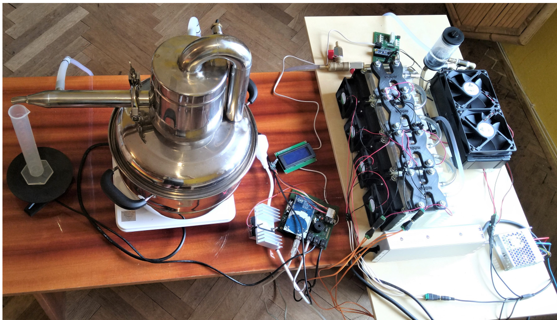
Obr. 3.1: Zapojenie destilačnej kolony a prídavnej chladiacej jednotky
