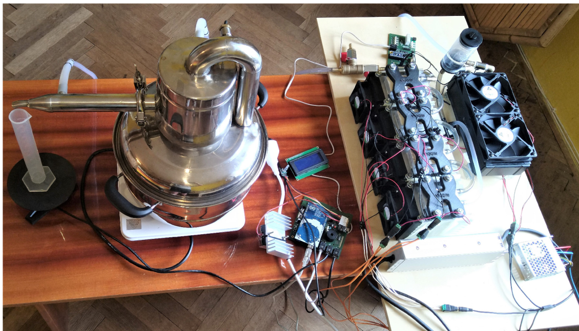
Obr. 3.1: Zapojenie destilačnej kolony a prídavnej chladiacej jednotky
