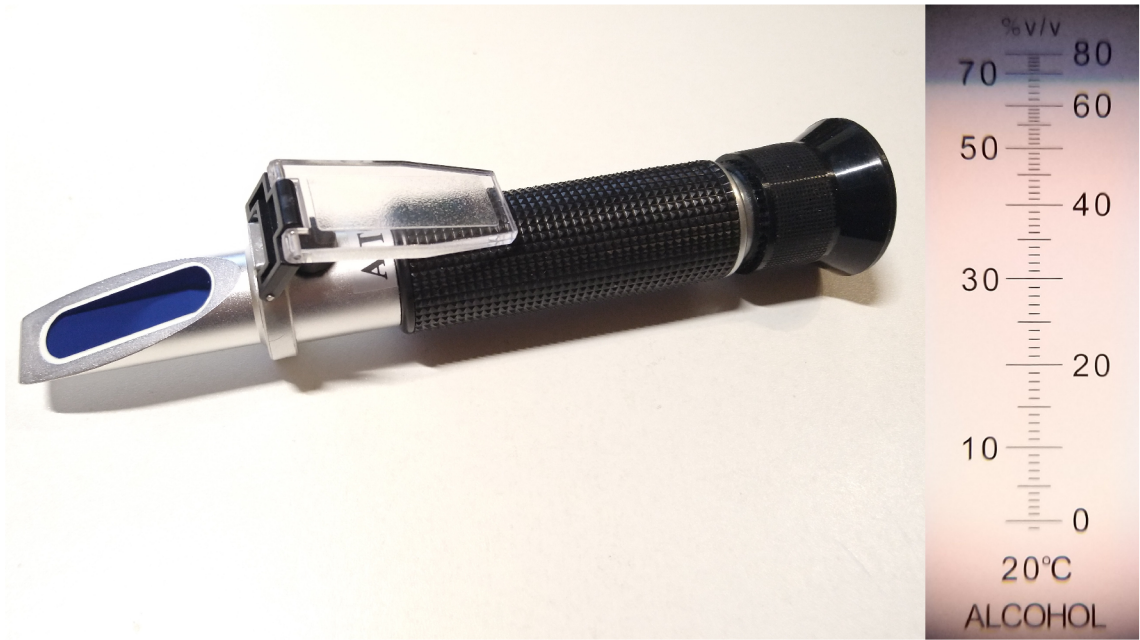
Obr. 1.6: Refraktometer a pohľad na stupnicu
