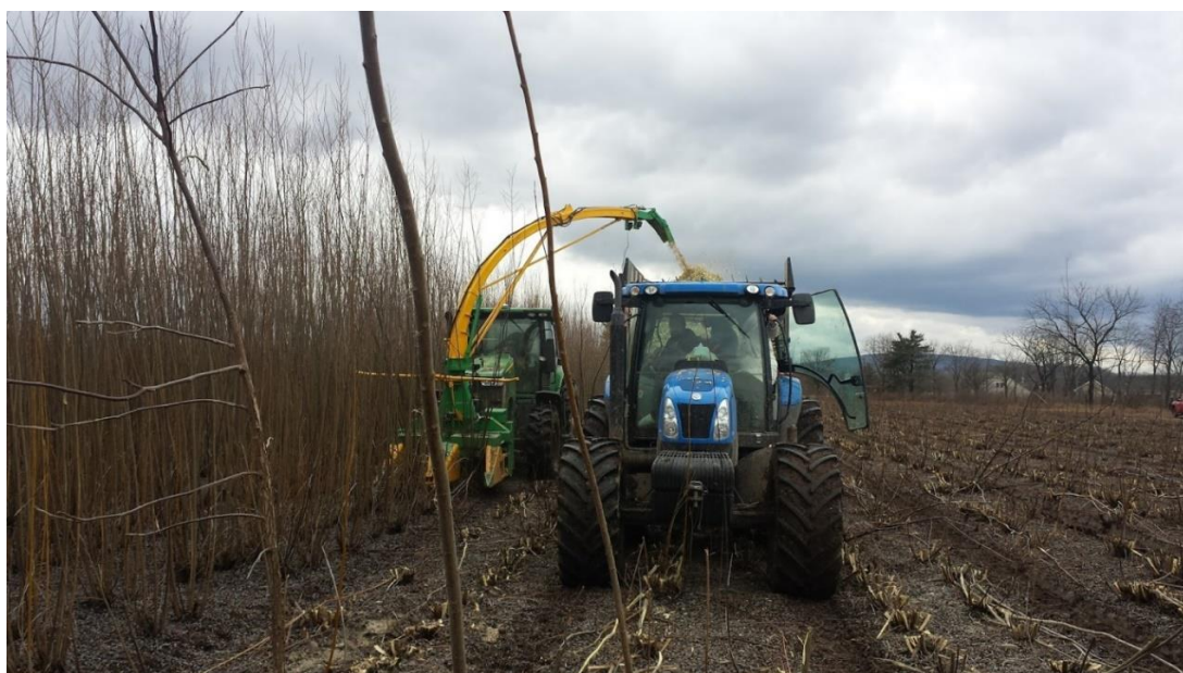
Obr. 4 Štěpkovací harvester (Bioenergy blog, 2017)
