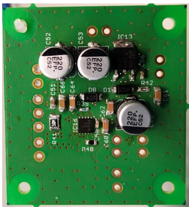
Obrázek 7.27 Zadní strana desky plošného spoje s budičem LM5113
