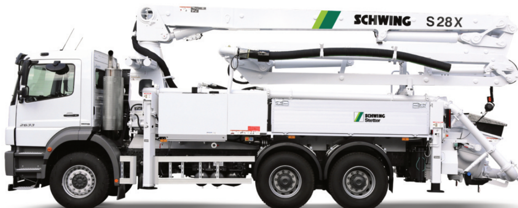
Obrázek č. 34 – Autočerpadlo SCHWING Stetter S 28 X, P 2020 [17]
