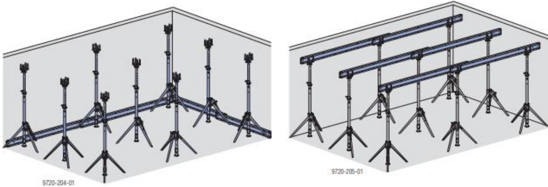
Obrázek 69: Postup sestavování stropního bednění Dokaflex 1-2-4 (30)
