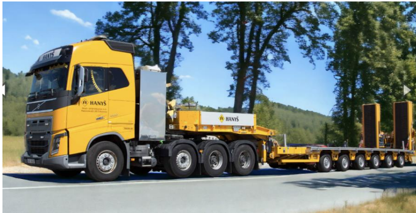
Obrázek 44: Souprava tahače Volvo FH16 750 8x4 a podvalníku Faymonville Multimax PA-X (17)
