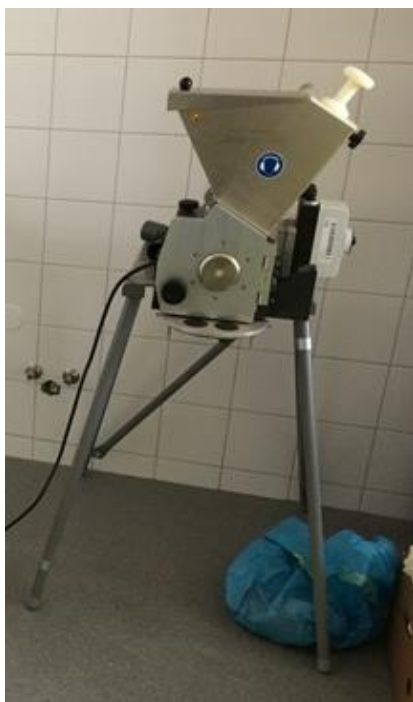
Obr. 10: Řezací mlýnek PULVERISETTE 15 FRITSCH/NĚMECKO, určený k homogenizaci nadzemní biomasy; (foto: Havlíčková; 2017).
