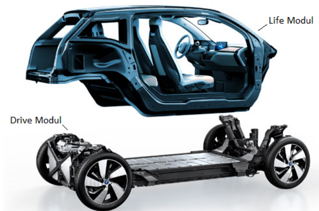
Obr. 11: Modulární architektura vozidla BMW i3 [22]
