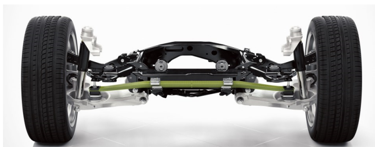
Obr. 15: Zadní náprava vozu Volvo XC90 s kompozitní listovou pružinou [41]
