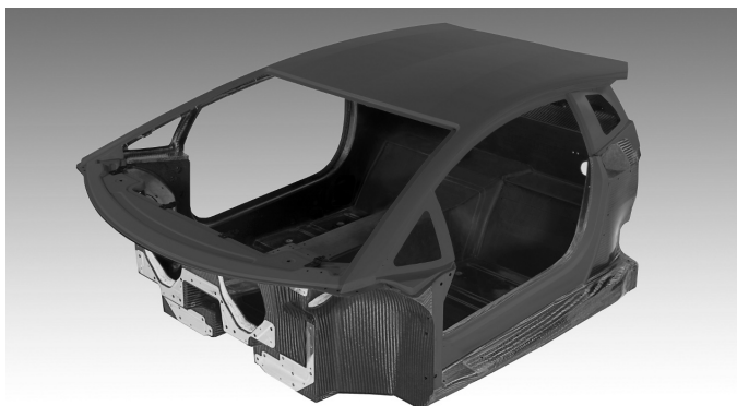
Obr. 13: Monokok automobilu Lamborghini Aventador [12]
