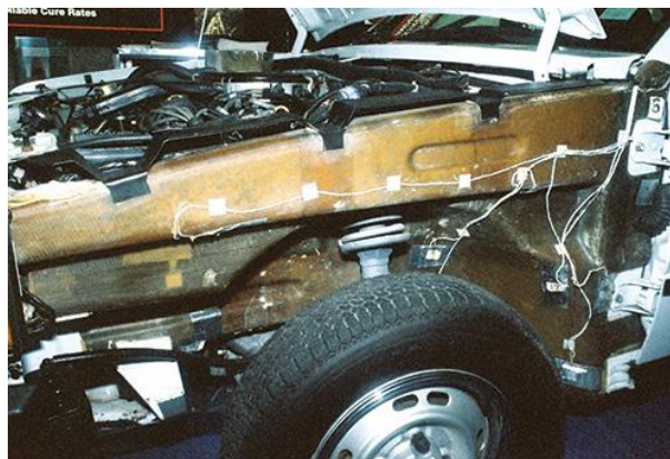
Obr. 12: Kompozitní přední část karoserie Fordu Escort z roku 1986 [31]
