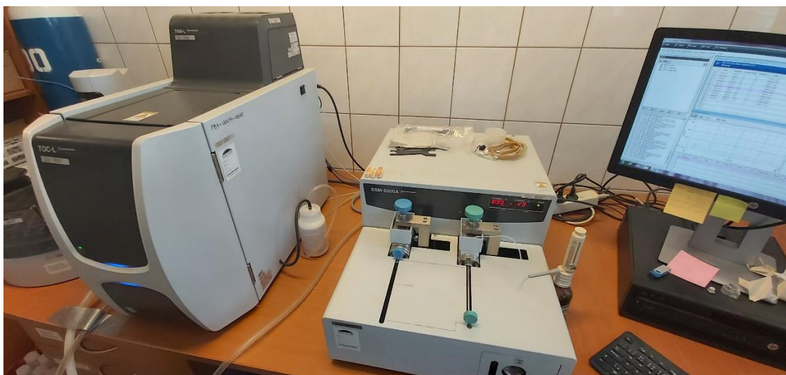
Obrázek 18: Analyzátor celkového C (TC)
