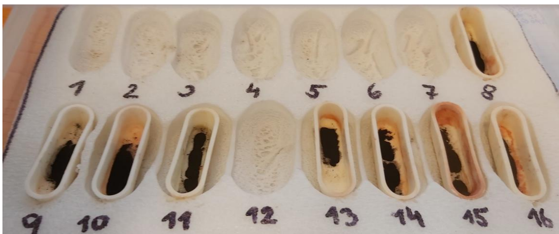
Obrázek 17: Lodičky s naváženými vzorky frakcí
