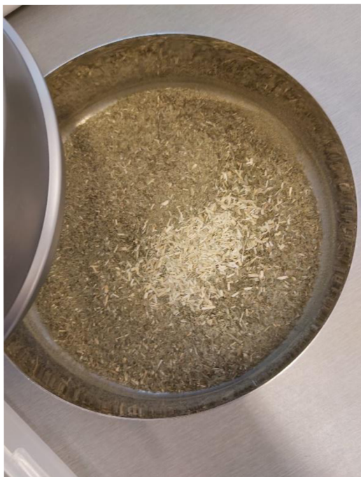
Obrázek 2: Homogenizace kukuřičné biomasy přes síto
