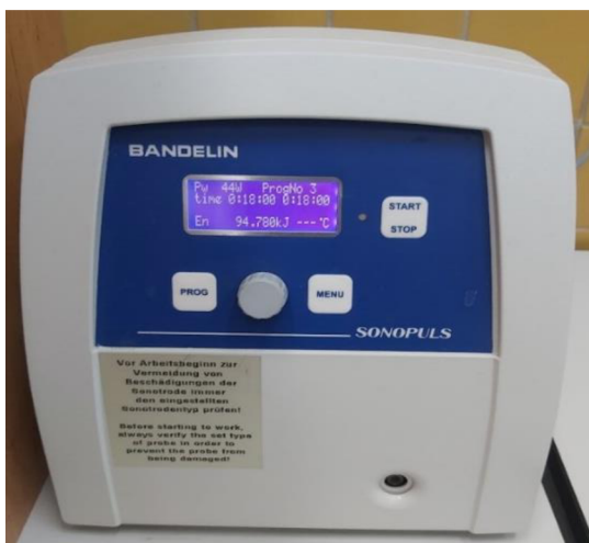
Obrázek 14: Ultrazvukový homogenizátor s příslušným nastavením
