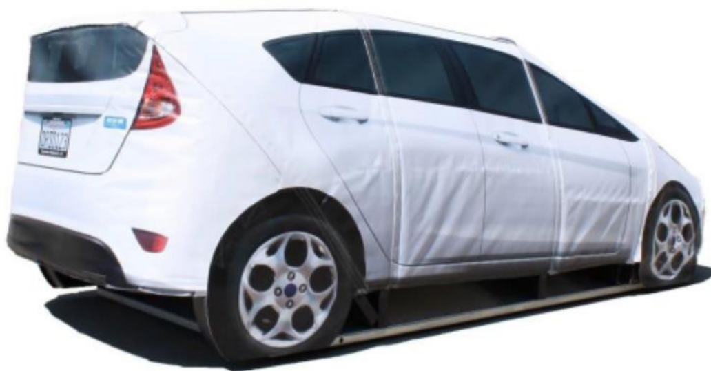
Obrázek č. 3: Ukázka cíle auta pro testování
