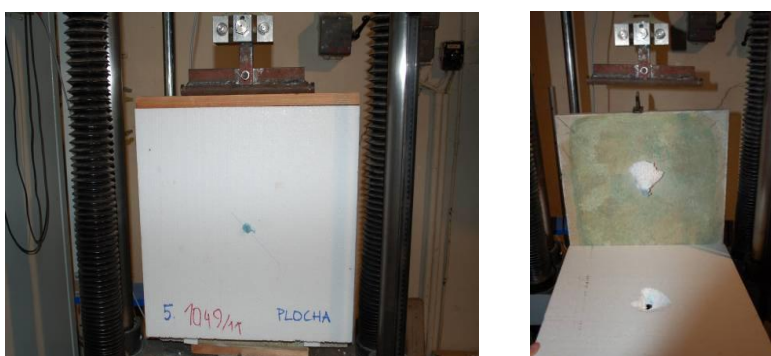
Obr. 10 Vzorek připravený ve zkušebním lisu a po ukončené zkoušce
