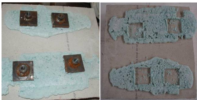
Obr. 8 Přilepení odtrhových terčů a vzorek po provedení odtrh.
