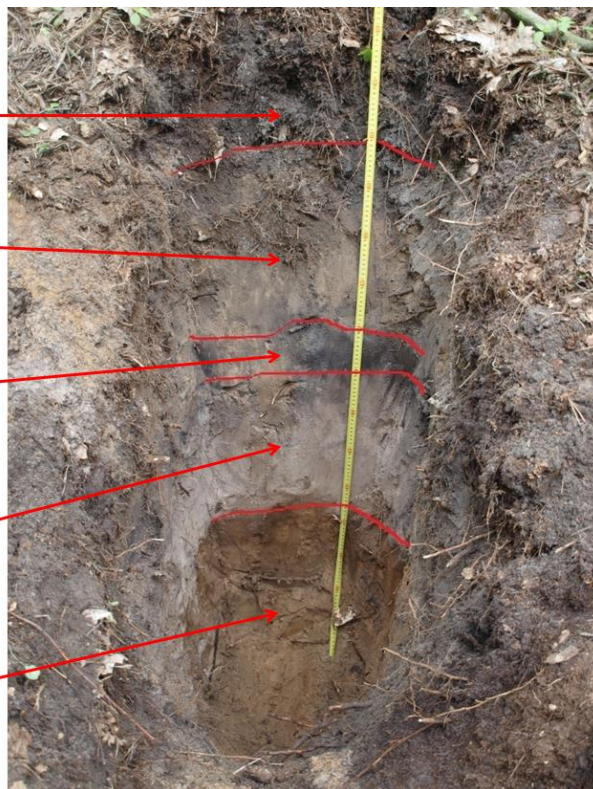
Obrázek č. 1 Sonda č. 1 s popisem jednotlivých horizontů (foto autor)
