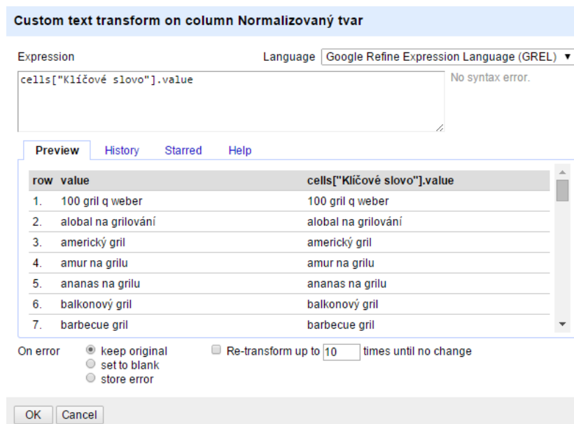
Obr. 17 Okno s možností zadat výraz pro provedení transformace s výrazem pro kopírování polí mezi sloupci
