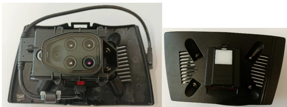
Obr. 46 Kamera Parrot Sequoia a senzor slunečního svitu v lóži
