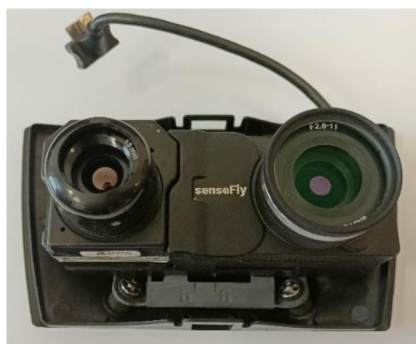
Obr. 45 Kamera Duet T v lóži
