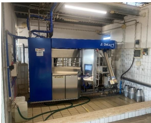
Obr. 5. Automatický dojící stroj (DeLaval)
