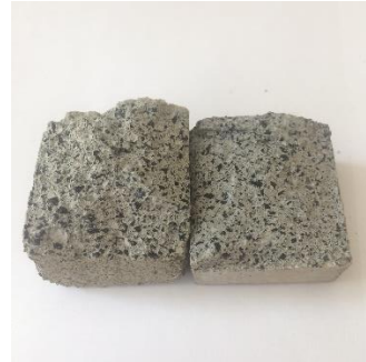
Obrázek 50: Struktura rozdrčeného trámečku po pevnosti v tlaku
