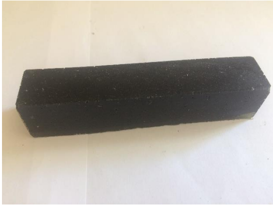
Obrázek 51: Odformovaný trámeček epoxidového kompozitu
