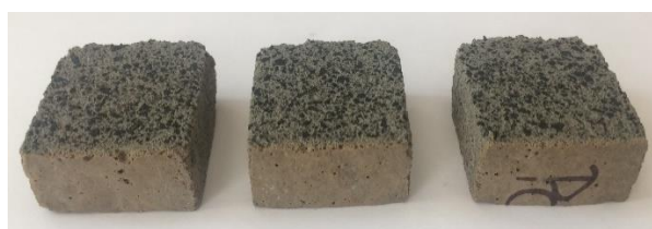
Obrázek 60: Vzhled destičky polymercementového kompozitu o rozměru 40 mm x 40 mm x 20 mm po teplotním šoku z teploty 150 °C na 18 °C
