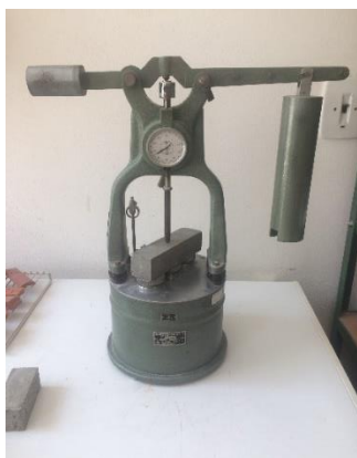
Obrázek 55: Zkušební zařízení pro stanovení tvrdosti povrchu
