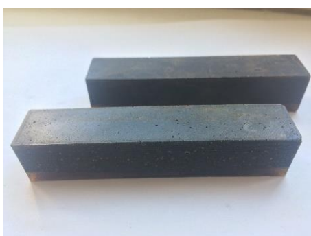
Obrázek 61: Vzhled trámečku epoxidového kompozitu po stanovení odolnosti proti teplotnímu šoku při zchlazení ze 180 °C na 18 °C
