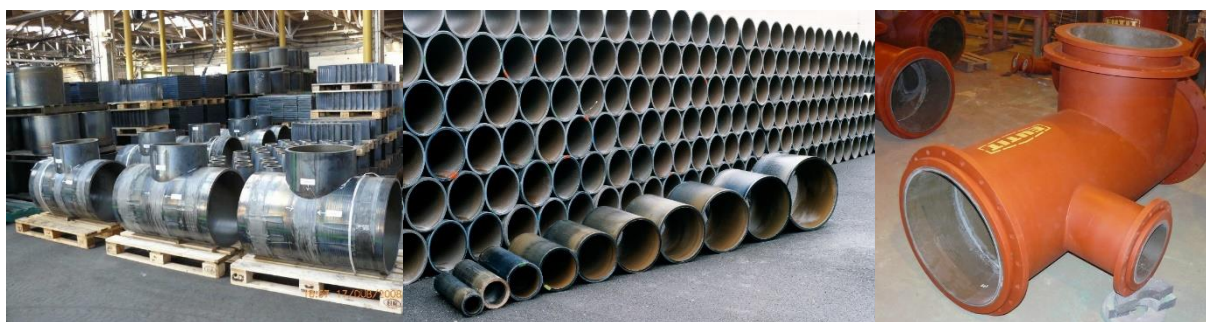
Obrázek 6: Vlevo - čedičové T kusy po vyrobení; uprostřed - vyrobené čedičové trouby; vpravo - T kus s čedičovým vnitřkem [4]
