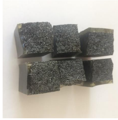
Obrázek 52: Struktura rozdrčeného epoxidového trámečku
