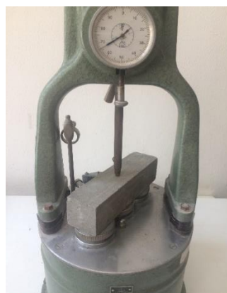
Obrázek 57: Uložení trámečku ve zkušebním zařízení
