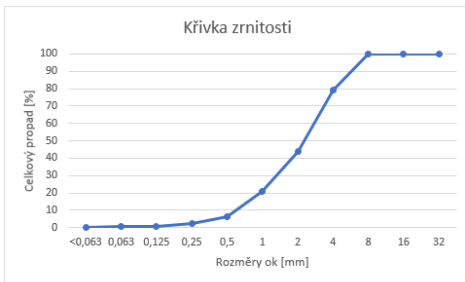
Obrázek 38: Křivka zrnitosti odkapů z výroby taveného čediče
