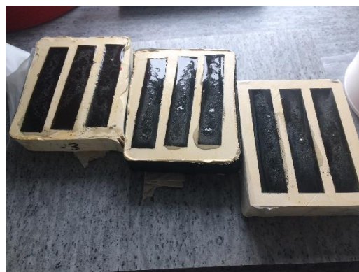
Obrázek 47: Epoxidová směs uložená do silikonové trojformy
