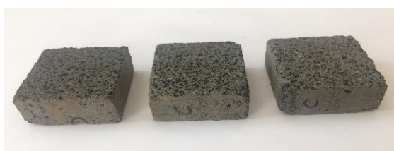
Obrázek 59: Vzhled destičky cementového kompozitu o rozměru 40 mm x 40 mm x 20 mm po teplotním šoku z teploty 150 °C na 18 °C
