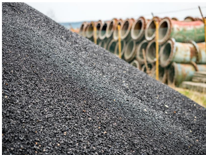
Obrázek 34: Odkapy z výroby taveného čediče
