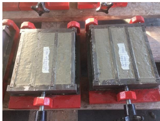
Obrázek 45: Polymercementová směs zhutněná v trojformě
