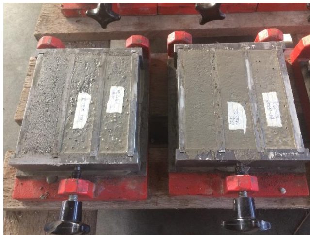
Obrázek 43: Cementová směs zhutněná v trojformě
