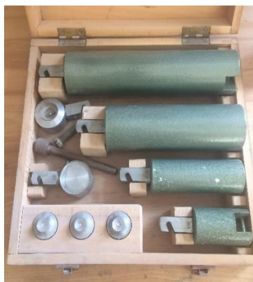
Obrázek 56: Sada zkušebních pomůcek pro stanovení tvrdosti povrchu
