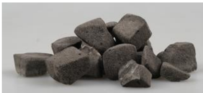
Obrázek 35: Vzhled pěnového skla [32]
