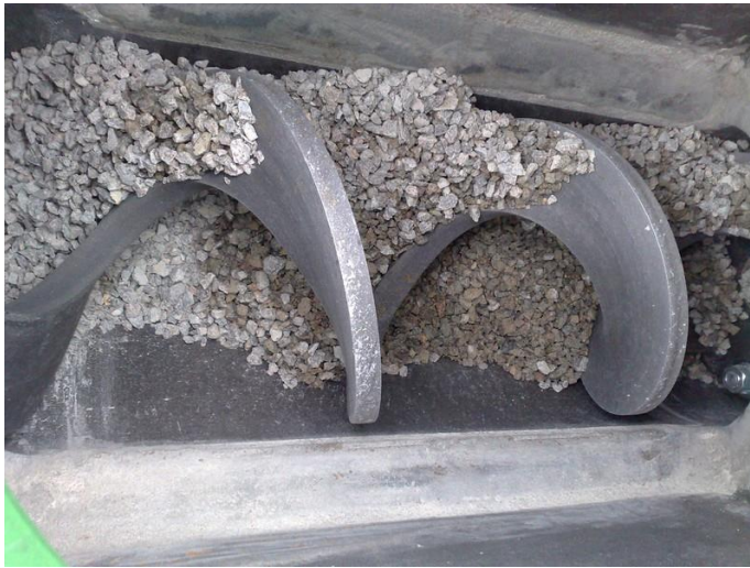
Obrázek 11: Vlevo - čedičový žlab ve šnekovém dopravníku; vpravo - dnový čedičový žlab a tvarovky v kanalizační vejčité stoce [4]
