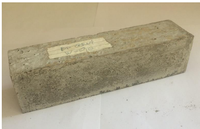
Obrázek 48: Odformovaný trámeček před stanovením pevnosti
