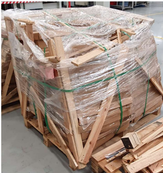
Obrázek 13: Poškozená balící jednotka pístů po přepravě
