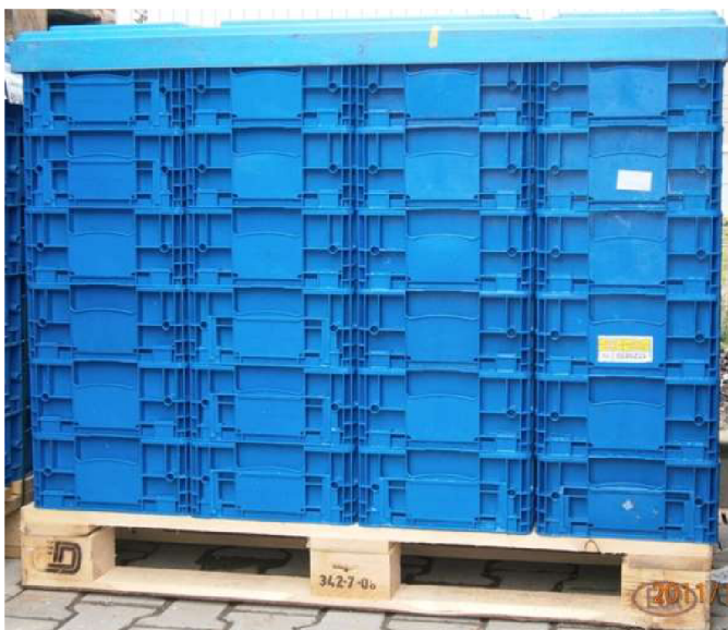
Obrázek 4: Naložená europaleta KLT boxy typu 4147 Zdroj: Vlastní zpracování
