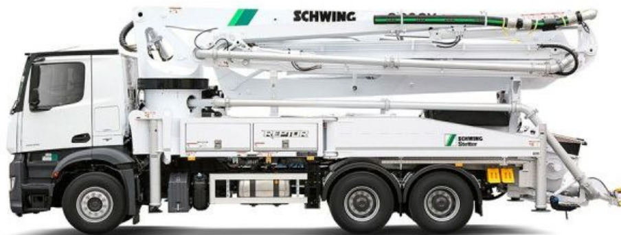
Obrázek č. 53 Autočerpadlo betonové směsi SCHWING S 38 SX REPTOR [37]
