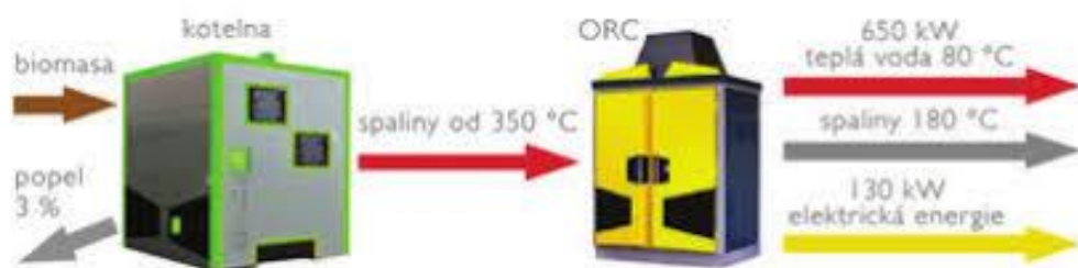
Obr. 13 Základní energetická bilance systému
