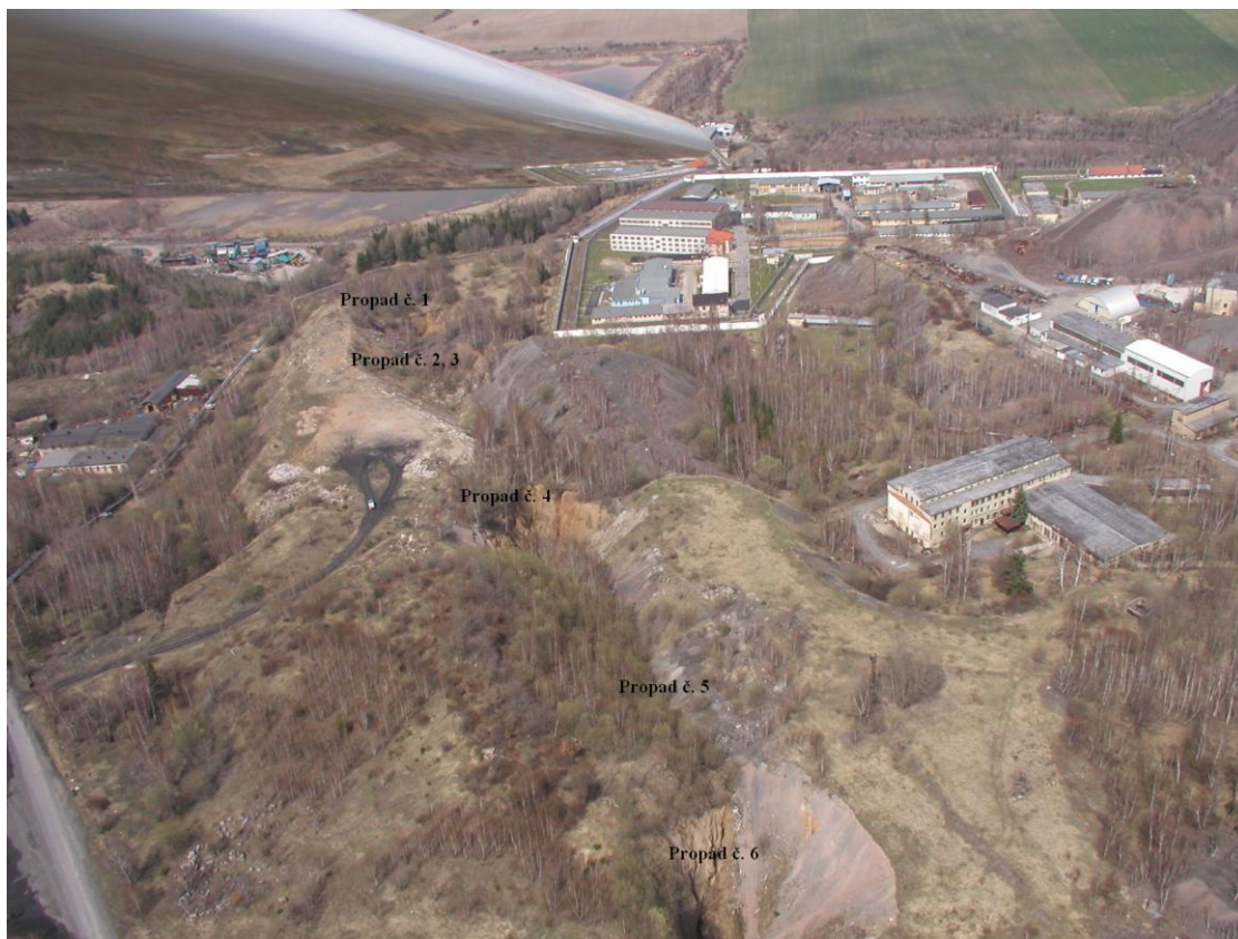
Obr. č. 5 Letecký snímek - propadové pásmo Bt4 Bytíz. Foto Ing. Škvor, DIAMO, s. p.
