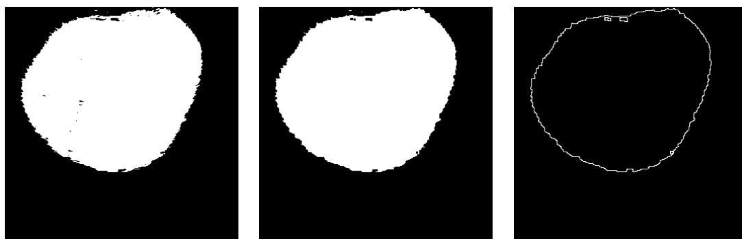
(a) Prvotne detekovaný objekt (b) Detekovaný objekt po dilatácii a následnej erózii (c) Detekovaná hranica segmentovaného objektu
