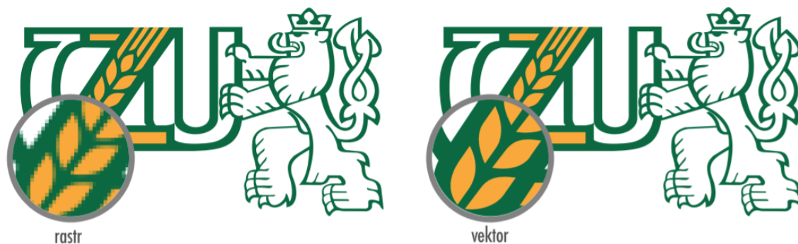
Obrázek 3: První obrázek je uložen v rastru, při zvětšení dochází ke ztrátě kvality a rozmazání. U vektoru je ostrost zachována. [vlastní ilustrace]
