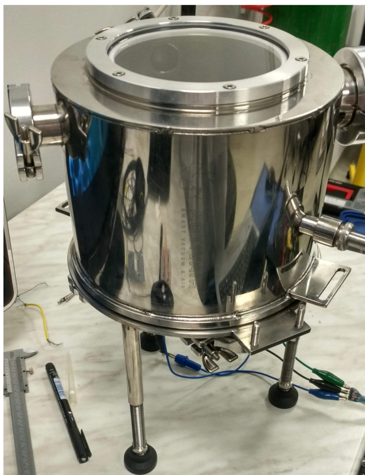
Obrázek 3.13: Environmentální komora a podstavec navržený Alešem Cahlíkem [3].
