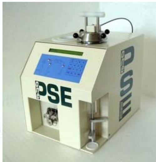
Obrázek č.19: Pracovní oblast metody PSE a zařízení pro jednokrokovou PSE [30,32]
