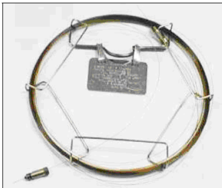
Obrázek č.26: Typická GC kapilární kolona [38]
