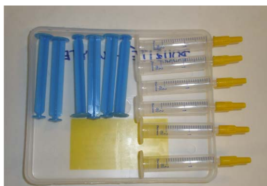
Příloha č. 16: Filtrace přes stříkačky
