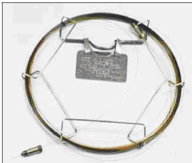
Obrázek č.26: Typická GC kapilární kolona [38]
