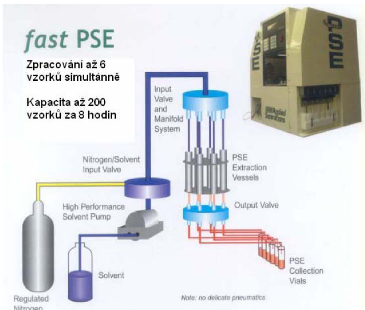
Obrázek č.20: Zařízení pro rychlou (simultánní) PSE extrakci [32]
