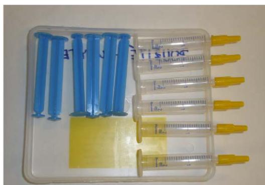
Příloha č. 16: Filtrace přes stříkačky
