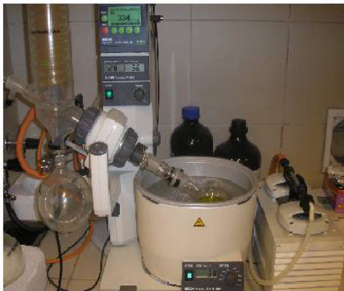
Příloha č. 13: Vakuová odparka
