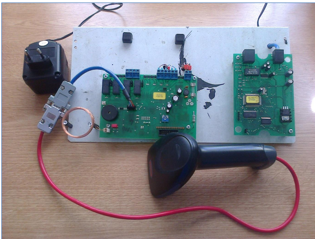
Obrázek IV.1: Testovací elektronika turniketu
