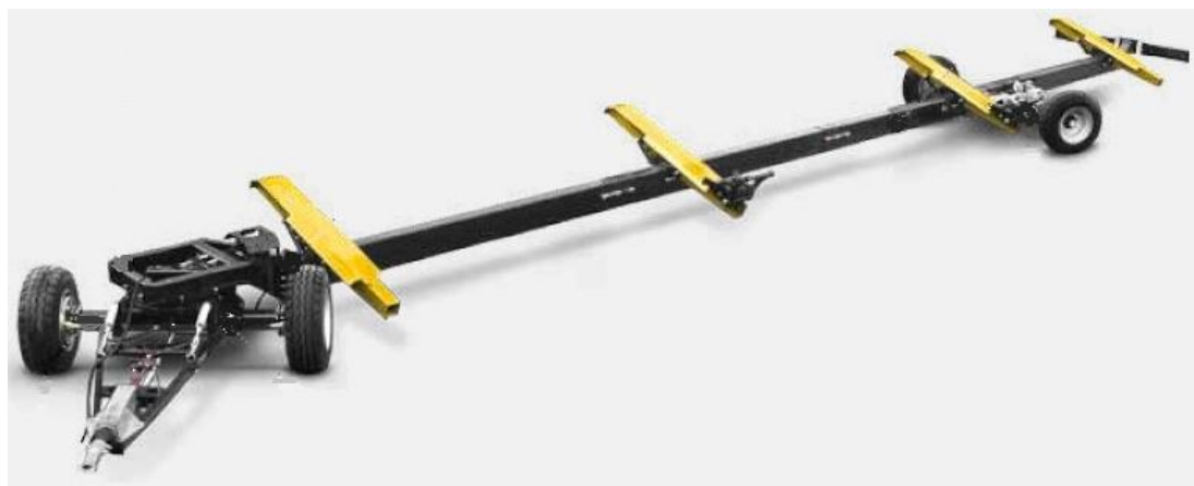
Obrázek 5: Přívěs Biso profi steer- rám tvořený jedním ocelovým profilem obdélníkového průřezu
