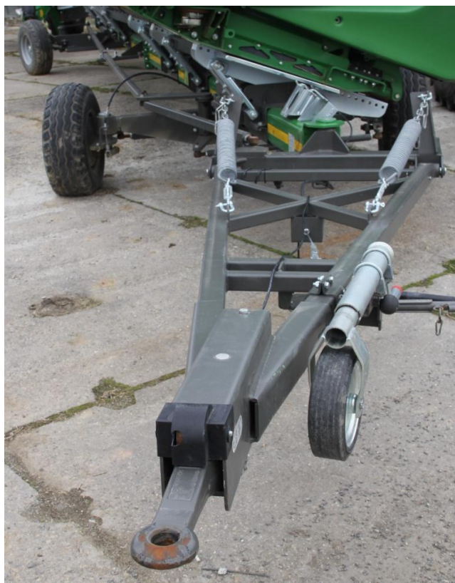
Obrázek 6: Tažná oj s odlehčovacími pružinami a opěrným kolečkem
