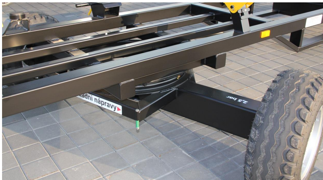
Obrázek 13: Zadní náprava říditelná točnicovým řízením
