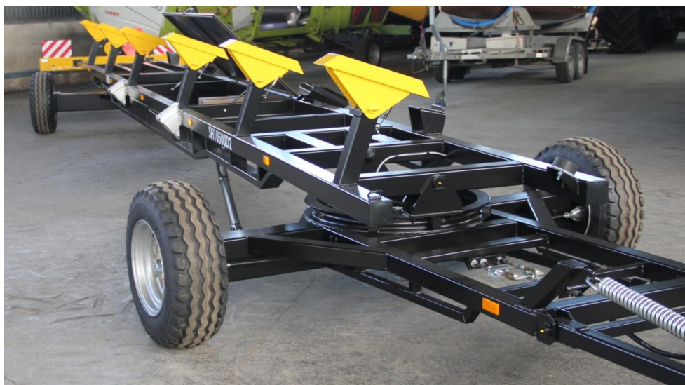
Obrázek 24: Přívěs typu SH s točnicovým řízením na obou nápravách
