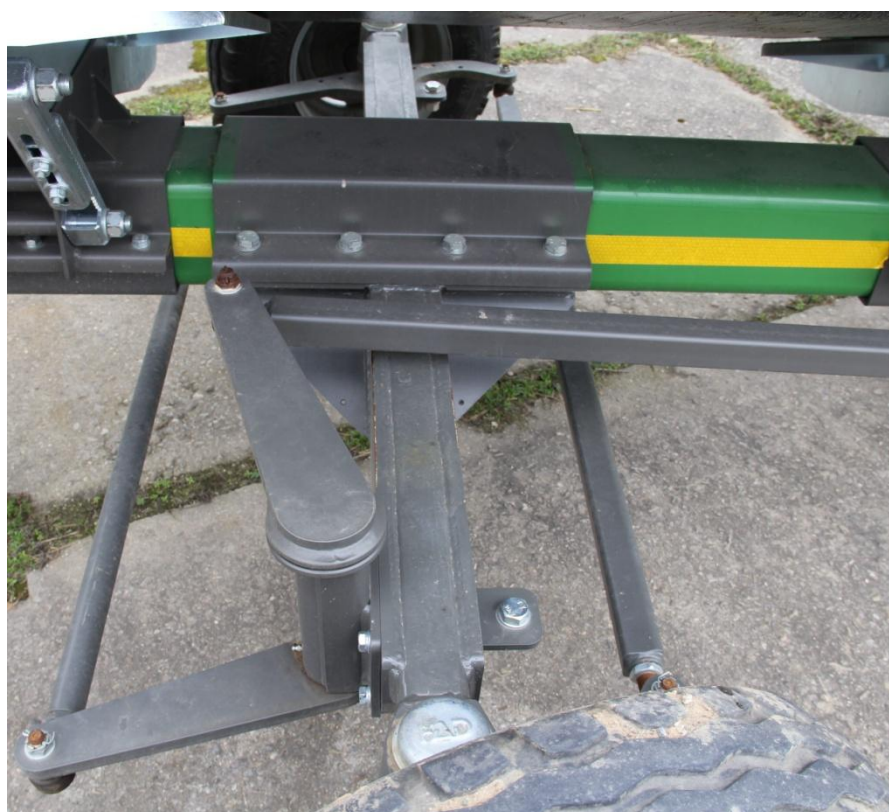
Obrázek 14: Zadní náprava říditelná automobilovým řízením
