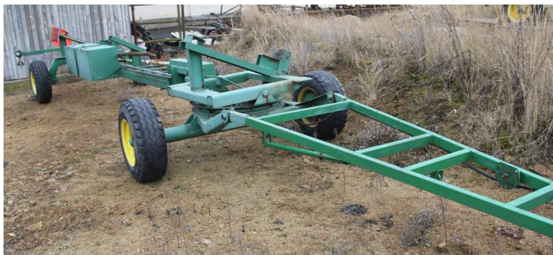
Obrázek 22: Přívěs Fortschritt pro žací ústrojí E516, přestavěný pro adaptér John Deere
