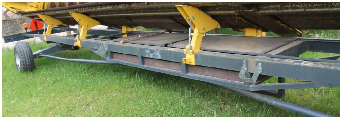
Obrázek 4: Vyztužení žebřinového rámu ve středové části
