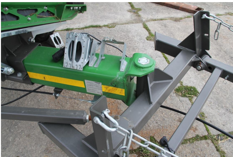
Obrázek 11: Uchycení oje na rámu přívěsu s automobilovým řízením
