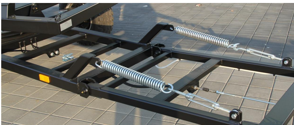
Obrázek 10: Uchycení oje na rámu přední nápravy s točnicovým řízením
