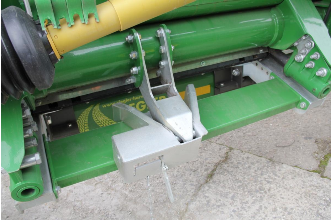
Obrázek 16: Zajišťovací mechanismus žacího adaptéru na přívěsu Ziegler
