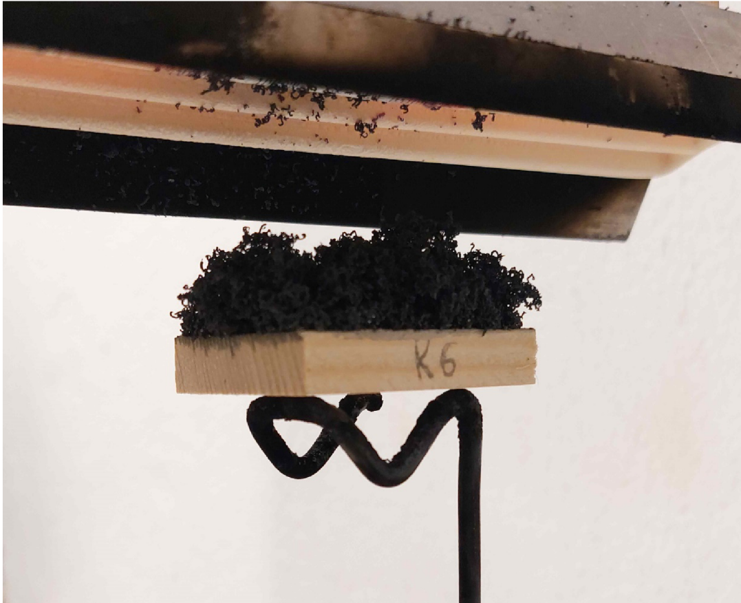
Obrázek 20. Expandovaný grafit ve formulaci s Klucelom na vzorku smrkového dřeva po dosažení jeho startovací teploty.
