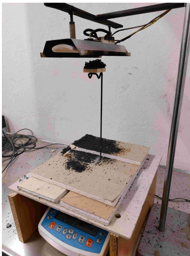
Obrázek 15. Testovací aparatura pro zkoušku sálavým tepelným zdrojem.
