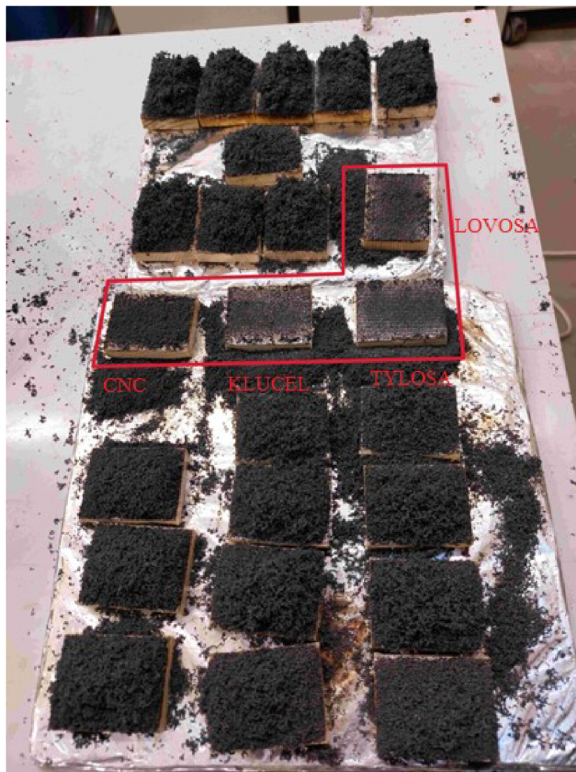
Obrázek 29. Vzorky s vrstvou expandovaného grafitu po testu soudržnosti se dřevem a kompaktnosti vrstvy (zleva nanocelulóza, Klucel, Tylosa, nahoře Lovosa).
