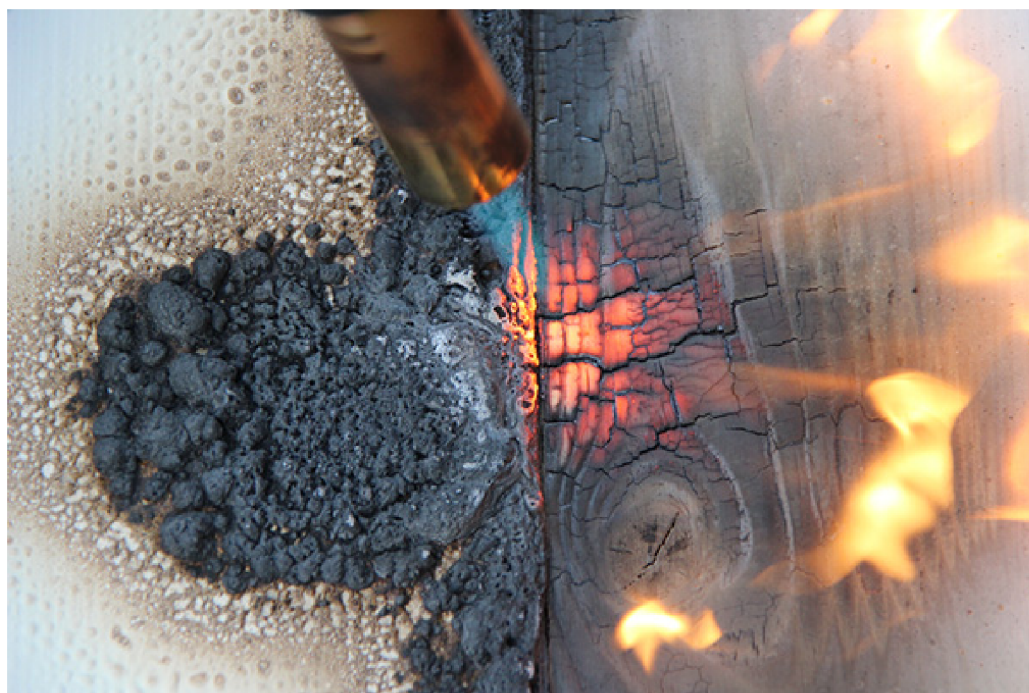
Obrázek 2. Dřevo ošetřené intumescentním nátěrem (vlevo) a neošetřené dřevo (vpravo) při působení tepla. Zdroj: Envirograf, 2016
