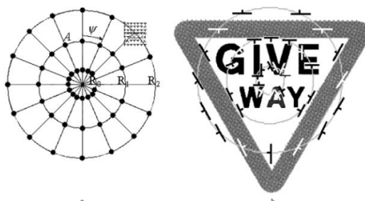
Obrázek 11: a) FOSTS senzor s fixačními body, b) Detekované hrany ve fixačních bodech
