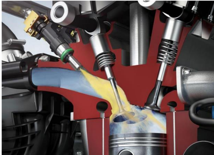
Obrázek 4 Sací potrubí a spalovací komora zážehového motoru bez přímého vstřiku [35]
