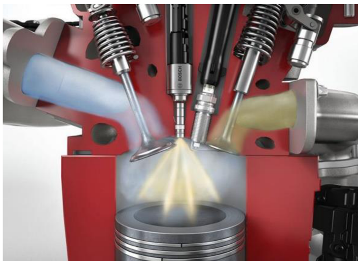
Obrázek 5 Sací potrubí a spalovací komora zážehového motoru s přímým vstřikem [35]
