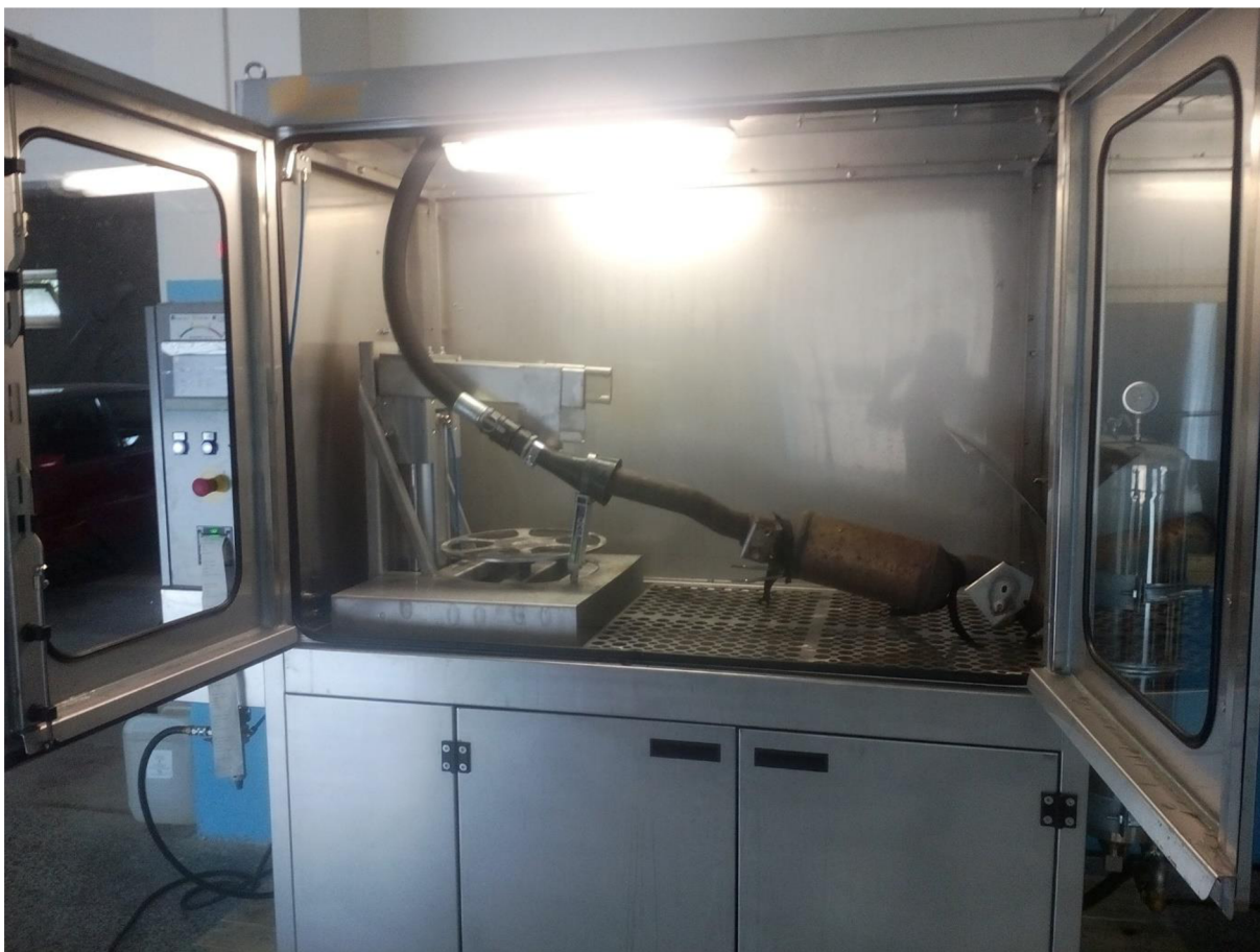
Obrázek 13 Zařízení FLASH CLEANER MACHINE 1000 s filtrem pevných částic upevněným a připraveným na čištění [54]
