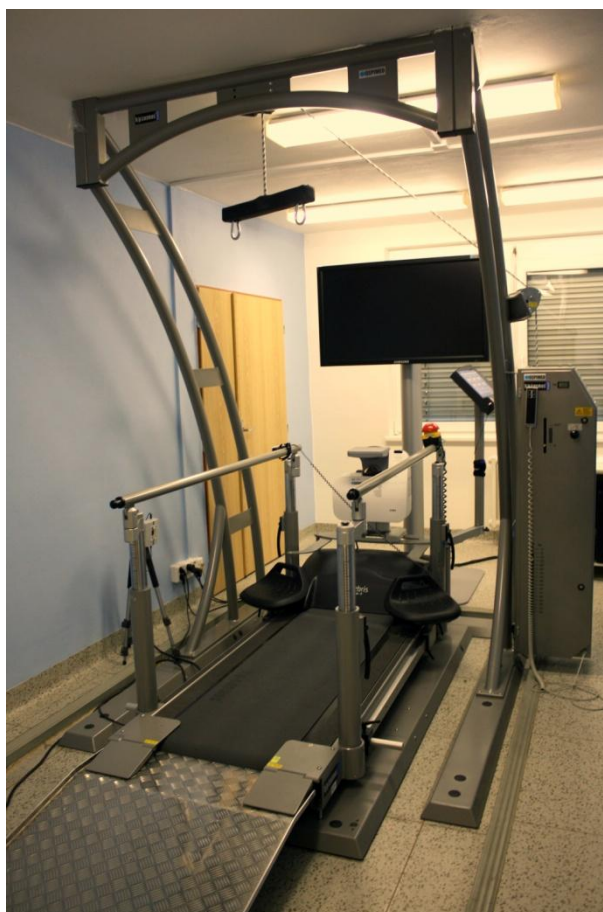
Obrázek 5 Běžící pás se zabudovanou silovou plošinou Zebris FMD-T (vlastní foto)
