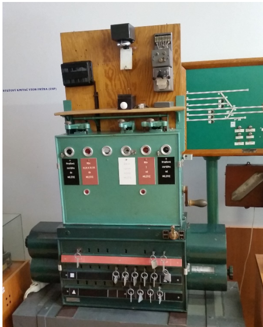
Obrázek 8: Bubnový přístroj s elektromechanickou nadstavbou – muzeum Hradec Králové (autor: Jan Bárta)
