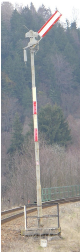
Obrázek 5: Mechanické návěstidlo – Žst. Dolní Lipka (autor: Jan Bárta)
