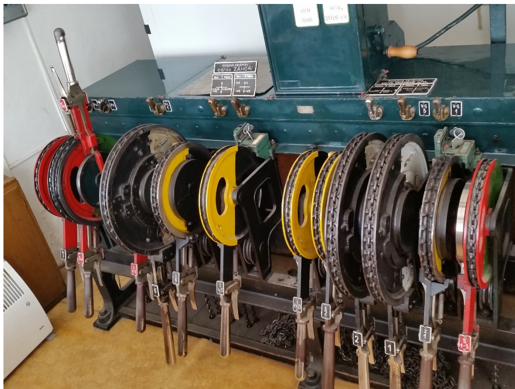
Obrázek 9: Mechanický pákový přístroj – Žst. Vlastec (autor: Jan Bárta)
