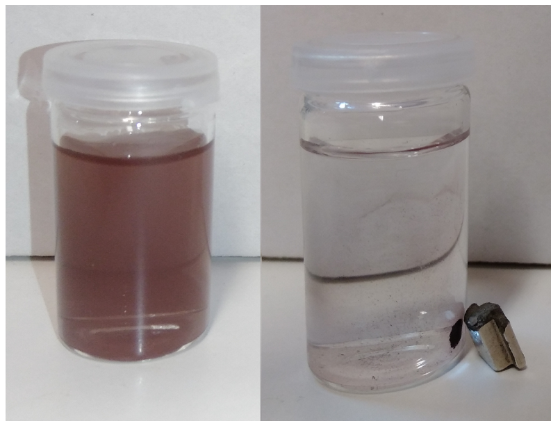
Obrázek 5.5: Reakce \text{Fe}_3\text{O}_4@Au NPs na vnější magnetické pole.
