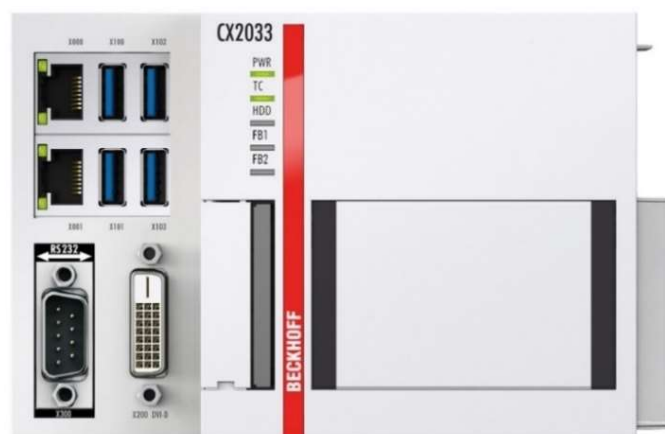
Obr. 5.4 – Průmyslové PC pro řízení, dostupné z [13]
