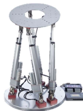
Obr. 3.3 – Stewartova platforma firmy Acrome, dostupné z [32]
