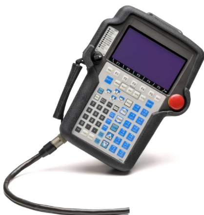
Obr. 3.5 – Teach pendant společnosti Fanuc, dostupné z [34]
