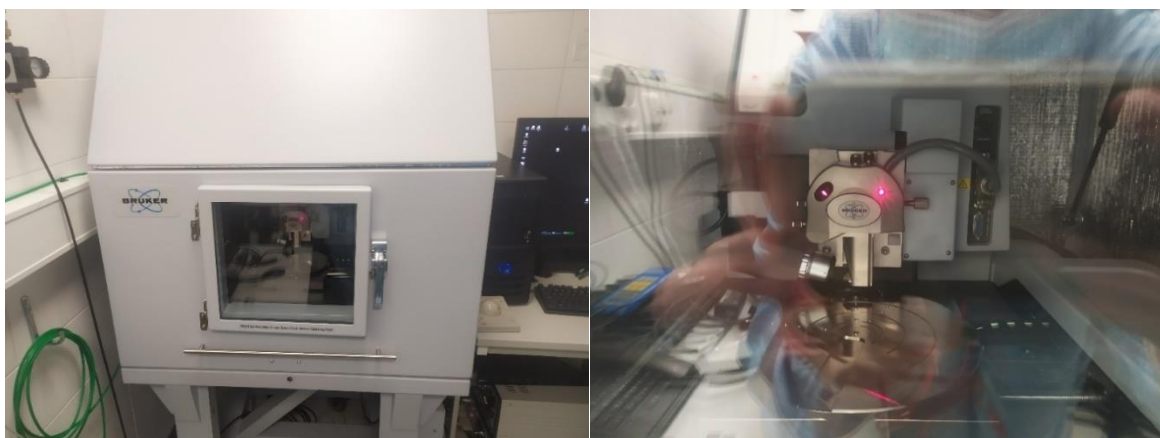
Obrázek 9: Mikroskop atomárních sil (BRUKER, Massachusetts, USA) využitý k pozorování sklíček.
