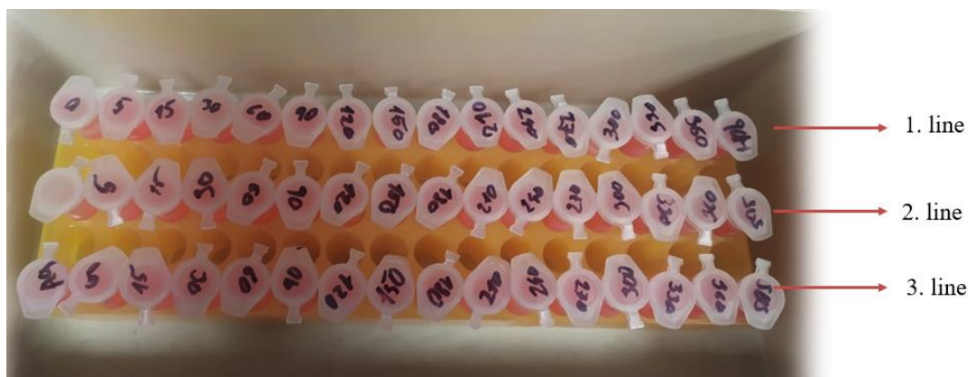
Obrázek 12: Vzorky rhodaminu B. 1. line obsahuje vzorky, které byly vystaveny světlu bez fotokatalyzátoru. 2. line obsahuje vzorky s fotokatalyzátorem \text{TiO}_2\text{-(H)} . 3. line obsahuje vzorky s fotokatalyzátorem \text{TiO}_2\text{-(H)-Ag} .
