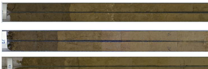
Obr. 7: sondy z erodovaných částí
