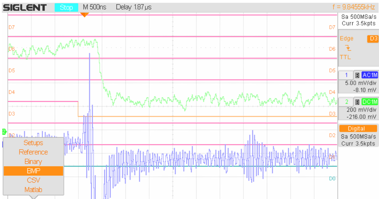
Obrázek 32 – Osciloskopem změřený průběh signálu při sepnutí tranzistoru
