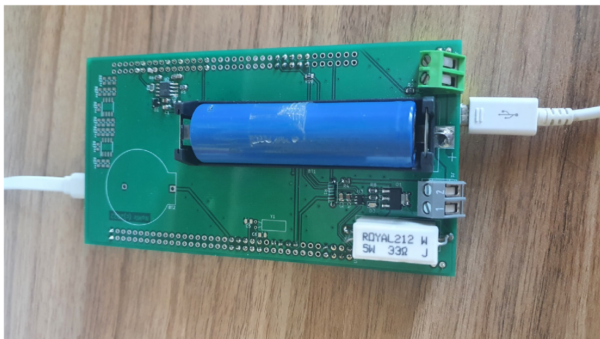
Obrázek 30 – Testovaný MCU s DSP pro potřeby měření a s připojeným článkem HT Li-Ion ICR18650T
