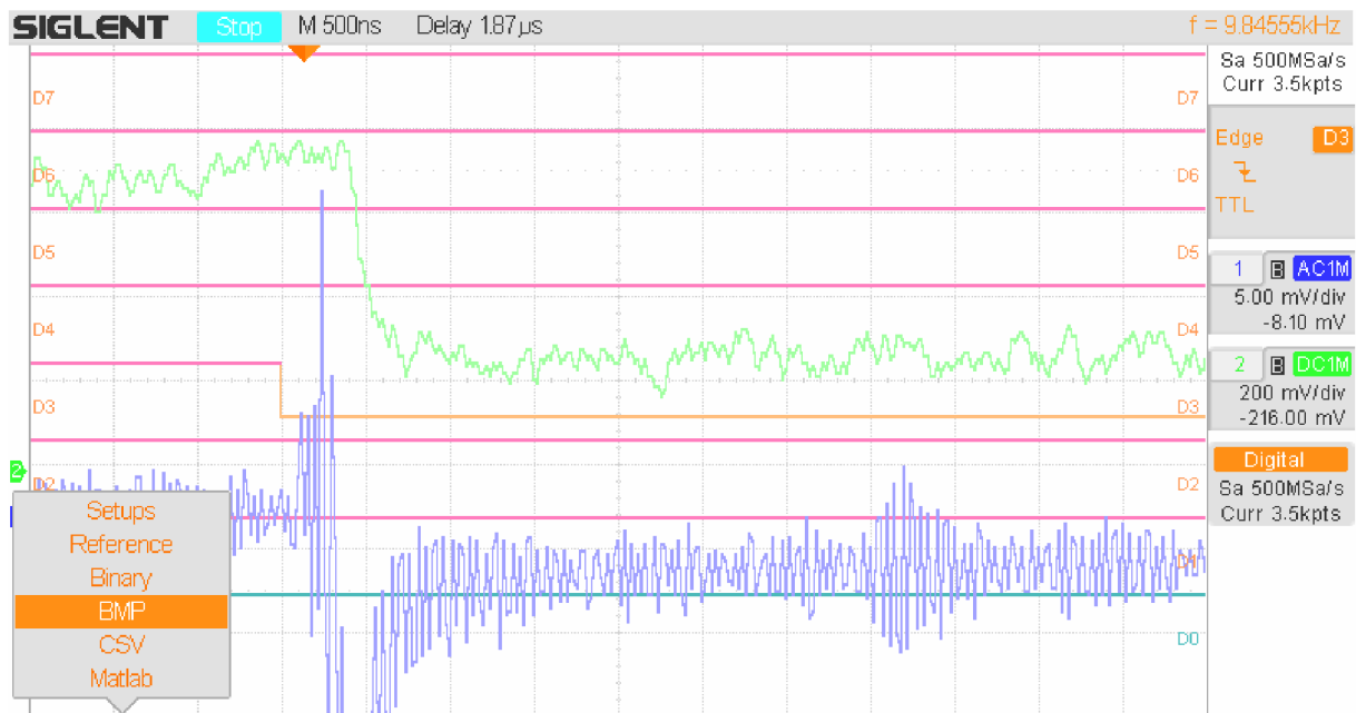
Obrázek 32 – Osciloskopem změřený průběh signálu při sepnutí tranzistoru
