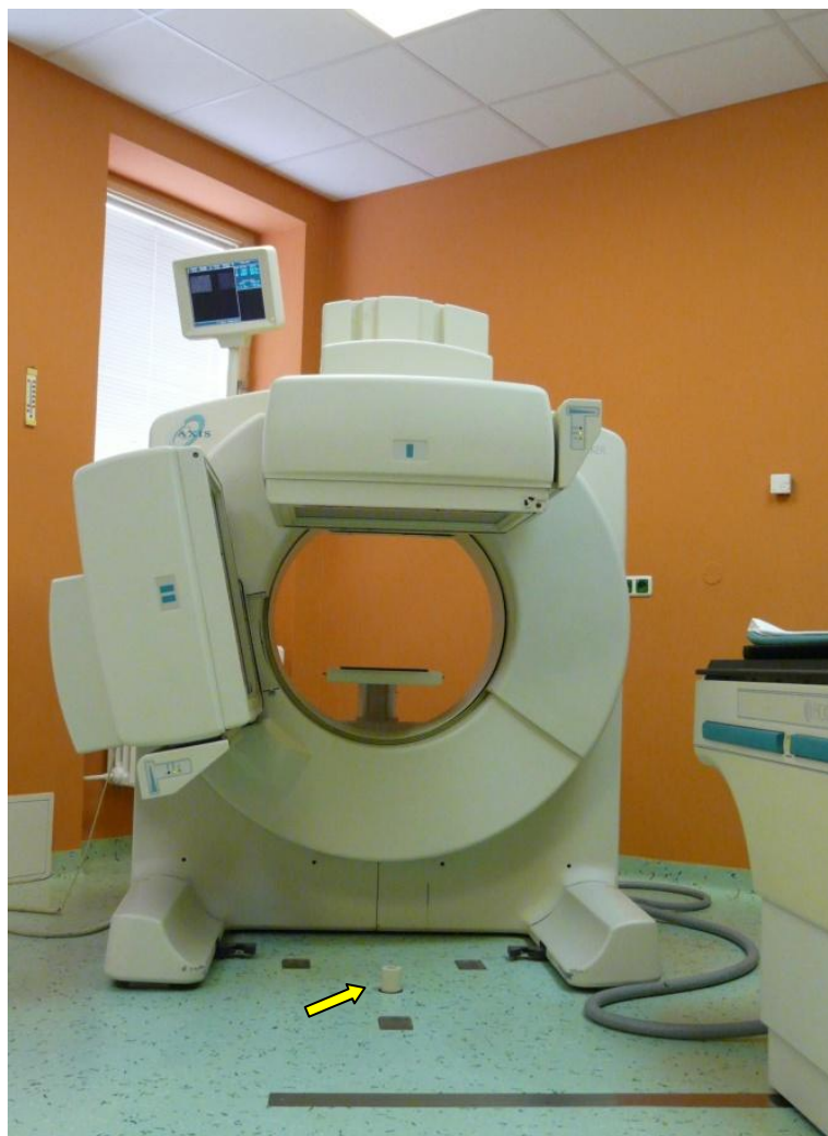
Obrázek č. 13: Nastavení detektoru do šikmé a vodorovné polohy pro provedení testu.
