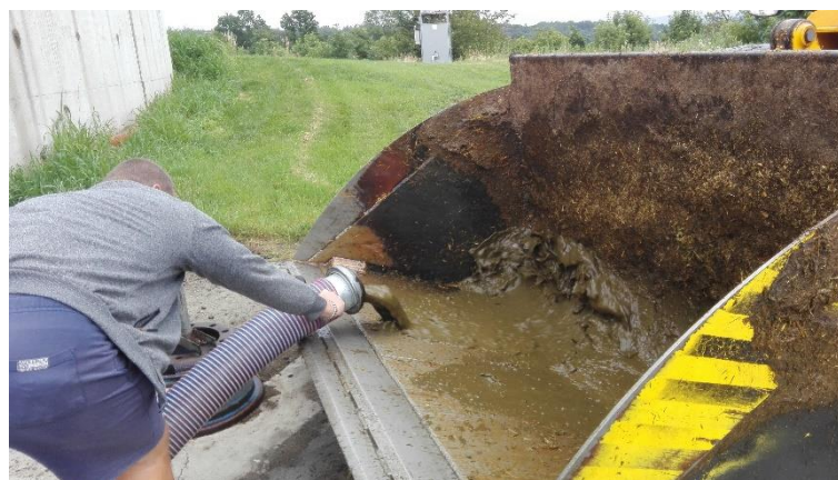
Obrázek 11 Odběr digestátu z bioplynové stanice
