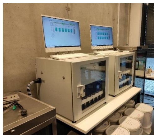
Obrázek 9 Respirometr ECHO - vlevo komora s testovacími nádobami, vpravo respirometr s ovládacím rozhraním
