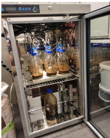
Obrázek 9 Respirometr ECHO - vlevo komora s testovacími nádobami, vpravo respirometr s ovládacím rozhraním
