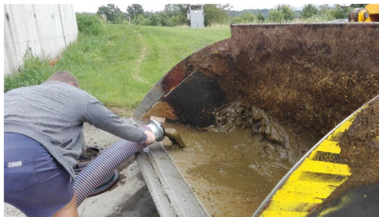
Obrázek 11 Odběr digestátu z bioplynové stanice
