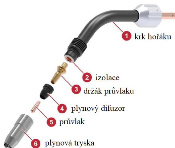
Obr. 26 Koncová část hořáku HGX [35].
