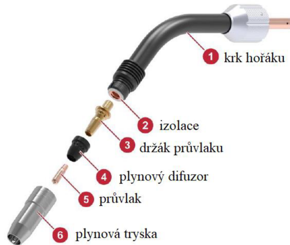
Obr. 26 Koncová část hořáku HQX [35].
