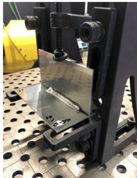
Obr. 43 Ustavení plechů pro koutový spoj.
