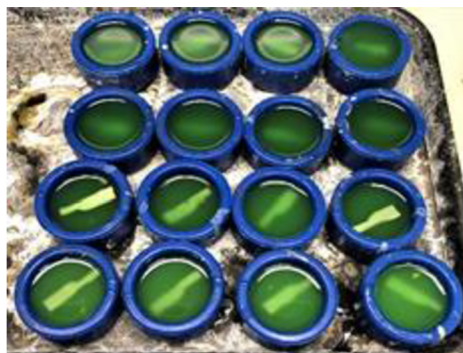
Obr. 39 Rozřezané vzorky zalité směsí.
